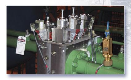
Температурный контроль гидрожидкости, подаваемой в 2/2-распределитель экструдерной установки
